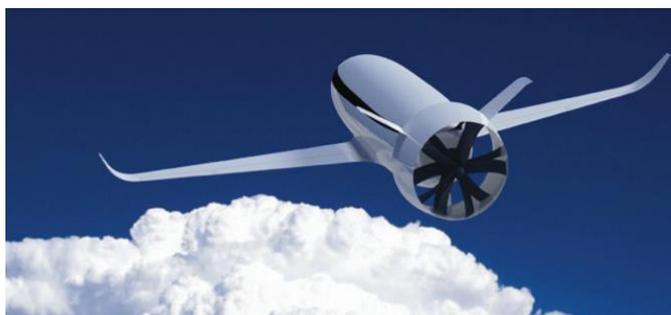
Asas inspiradas nas da natureza / Cauda substituída por motor direccional
