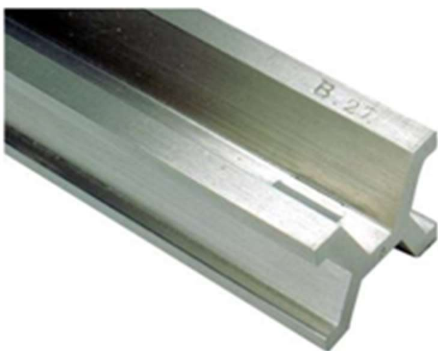
A barra de platina-irídio utilizada no protótipo do metro (1889 – 1960) 1
