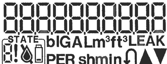
O contador de água está equipado com um ecrã LCD integrado. Estão disponíveis 10 dígitos para a apresentação do índice. Unidades disponíveis em conformidade com a norma europeia ou norma americana: m<sup>3</sup>, ft<sup>3</sup>; L, GAL, m<sup>3</sup>, ft<sup>3</sup>, L, por hora, minuto ou segundo.
